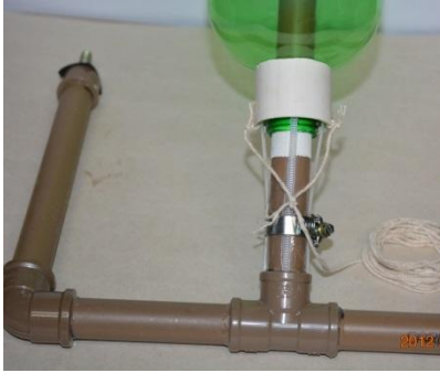
Fig. 19. Base com anel branco posicionado sobre as 4 “cabeças” de nylon.
