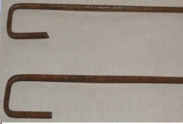
Fig. 20. Estacas que fixam a base de lançamento no solo.
