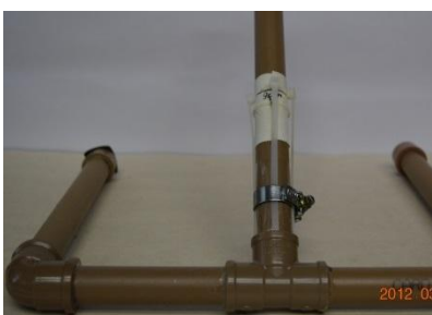
Fig. 16. Base com as 4 abraçadeiras de nylon presas com a abraçadeira de metal. Use 8 abraçadeiras!
