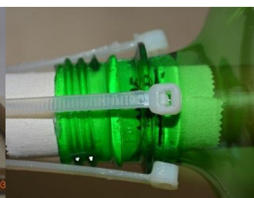
Fig. 17. Posição das cabeças das abraçadeiras sobre o anel sustentação.
